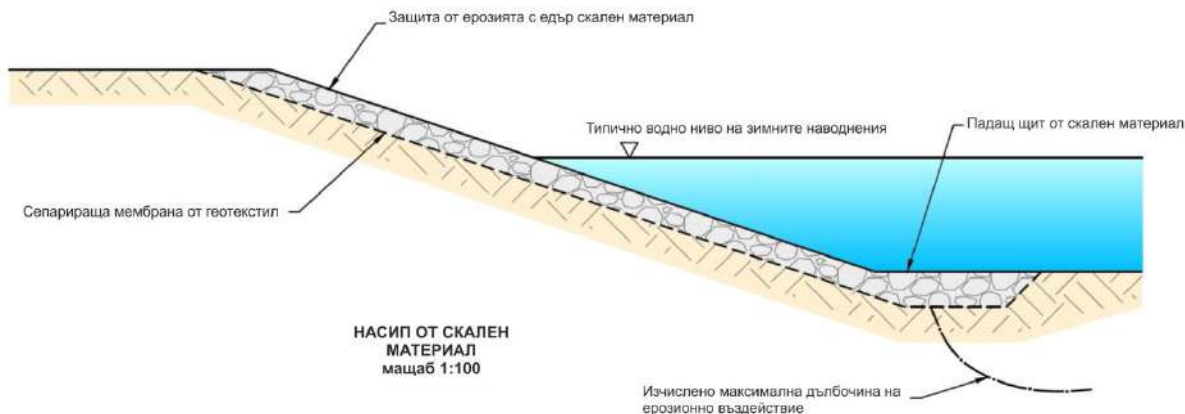
Фигура 3-8 Напречен разрез на брегова защита със скален материал
