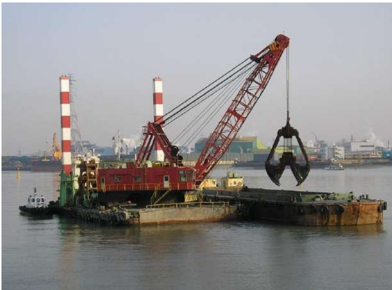
Фигура 3-1 Механична грайферна драга
