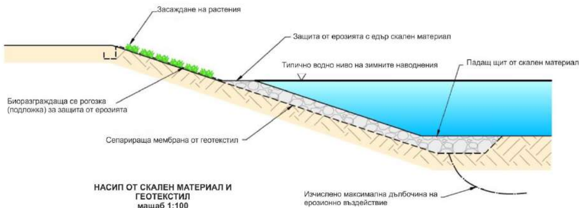
Фигура 3-9 Напречен разрез на брегова защита със скален материал и антиерозионни растителни подложки
