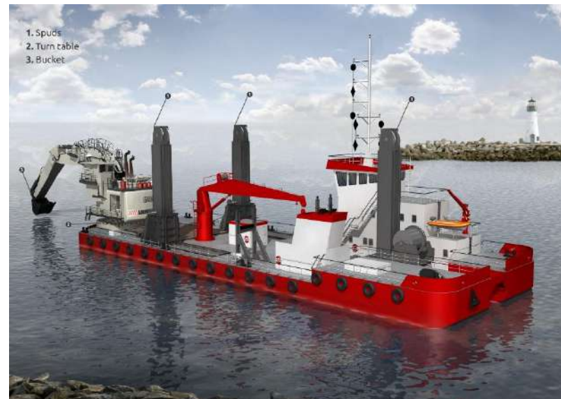
Фигура 3-2 Механична драга с обратна лопата
