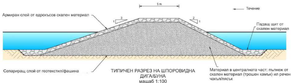
Фигура 3-5 Напречен разрез шпоровидна дига/буна
