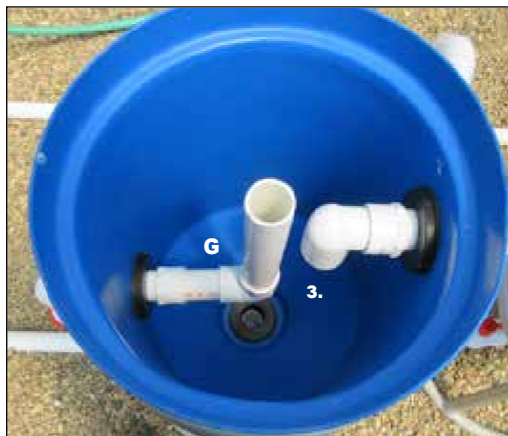
Резервоар за избистряне с радиален поток: Изглед отвътре
