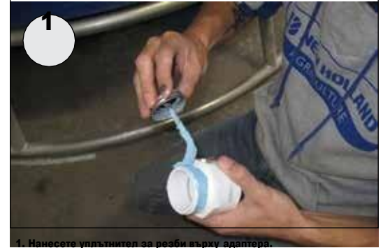
1. Нанесете уплътнител за резби върху адаптера.
